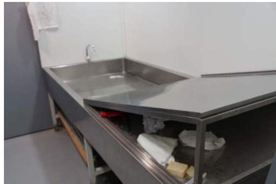
印刷前受印紙張必須加濕，為使加濕均勻所特製的加濕台
